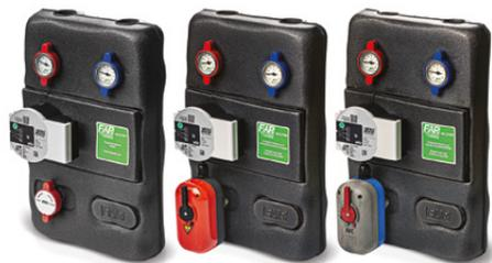
gruppi dotati di valvola miscelatrice motorizzata a 3 punti permettono, grazie all'impiego di una centralina elettronica, di comandare un impianto a punto fisso o con regolazione climatica. Il gruppo di rilancio dotato di valvola miscelatrice modulante è indicato per essere controllato da una centralina
